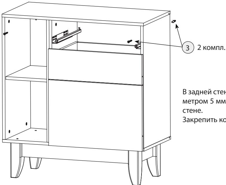
В задней стенке через ребро жесткости просверлить отверстие диаметром 5 мм и через него разметить место для установки дюбеля в стене.
