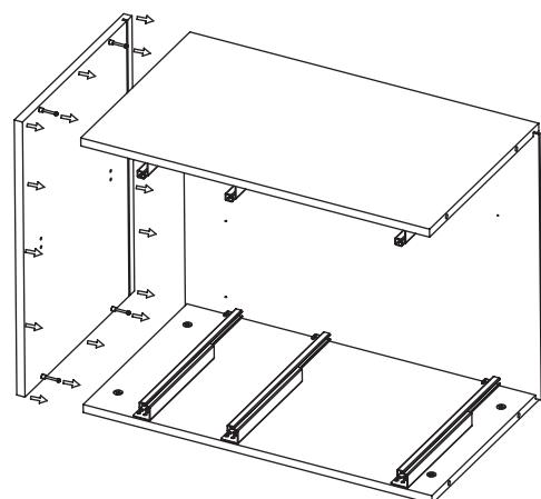
После соединения эксцентрики закрутить по часовой стрелке до упора.
