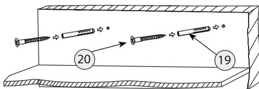
Предварительно просверлить отверстия диаметром 5 мм в ребре жесткости.
