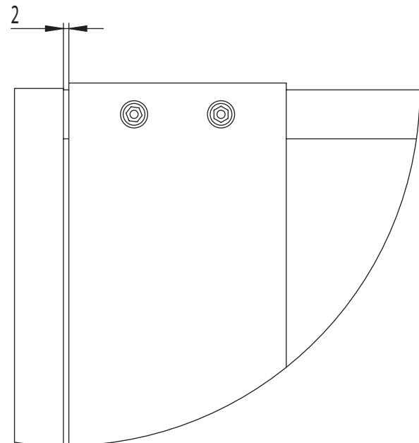
Между монтажной планкой и боковой стенкой необходимо обеспечить зазор - 2 мм. Для этого проложите между боковой стенкой и монтажной планкой пластиковую шайбу (11), которая идет в комплекте.
