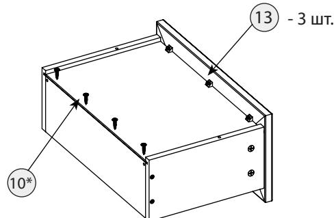
\*Необходимо предварительно просверлить отверстия строго по центру торца задней стенки сверлом d=3мм, глубиной 25мм.
