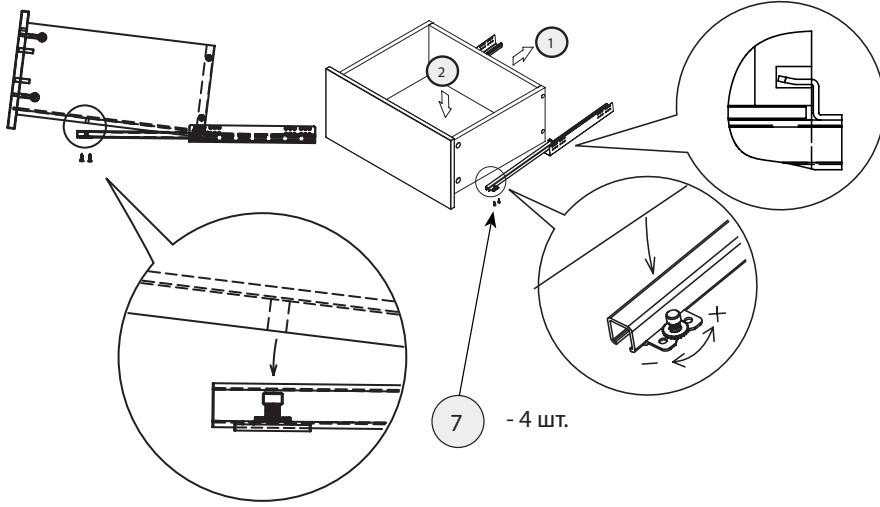
Регулировка ящика по высоте производится с помощью поворота регулировочного колесика (+3 мм)
