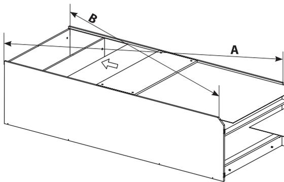
Закрепить задние стенки фиксаторами, как показано на рисунке. Прибить гвоздями стенку заднюю к стенке нижней и полкам, согласно схеме.
