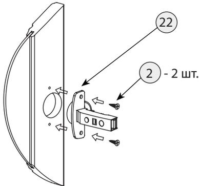
**Шаг 21** Установка ответной планки
