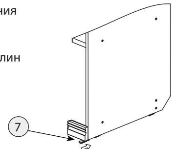
**Шаг 25** После установки изделия и регулировки всех механизмов необходимо все отверстия и видимые эксцентрики минификсов закрыть заглушками.**Правила по эксплуатации и уходу за мебелью**
