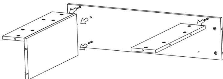
После соединения эксцентрики закрутить по часовой стрелке до упора.
