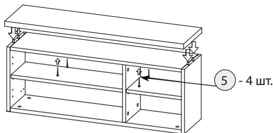
Прикрутить крышку, предварительно просверлив в стенке верхней отверстия диаметром 5 мм.
