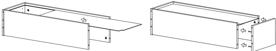
После соединения эксцентрики закрутить по часовой стрелке до упора.
