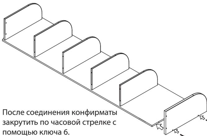
После соединения конфирматы закрутить по часовой стрелке с помощью ключа 6.
