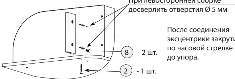
При левосторонней сборке досверлить отверстия  $\varnothing 5$  мм
