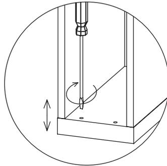
Изделие должно быть прикреплено к стене с помощью прилагаемого крепежа который подходит для крепления шкафа к стене из бетона или кирпича без пустот.
