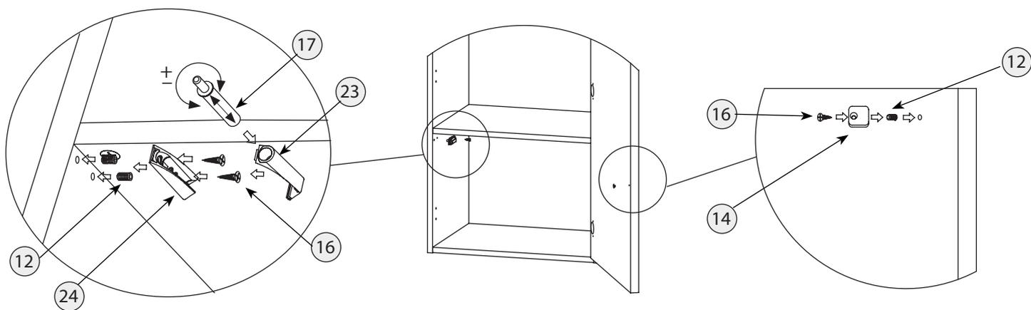
**Шаг 11** Установка петли на дверь**Шаг 12** Установка ответной планки**Шаг 13** Соединение петли с ответной планкой
