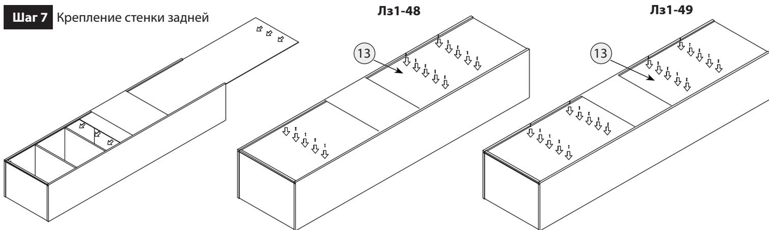
Зафиксировать заднюю стенку, прибить гвозди согласно схеме:
