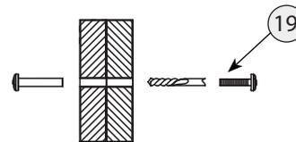
**Шаг 15** После установки изделия и регулировки всех механизмов необходимо все отверстия и видимые эксцентрики минификсов закрыть заглушками.**Правила по эксплуатации и уходу за мебелью**
