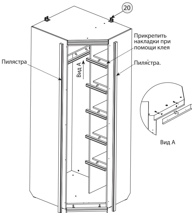
Для крепления пилasters досверлить 5 отв. Ø 5 мм. со стороны установки пилasters, закрепить пиластру шурупами: позиция (28) – 5 шт.
