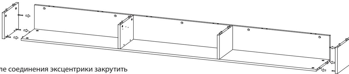
После соединения эксцентрики закрутить по часовой стрелке до упора.
