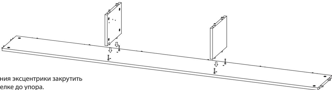
После соединения эксцентрики закрутить по часовой стрелке до упора.
