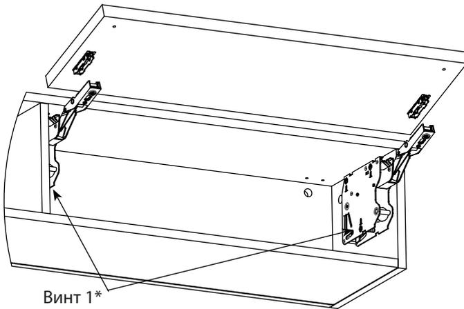
Отрегулируйте усилие откидывания двери (винт 1\*). Дверь должна останавливаться в любом положении при открытии на угол больше 45°.
