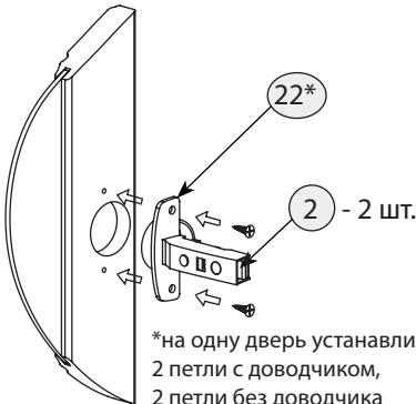
**Шаг 19** Установка ответной планки
