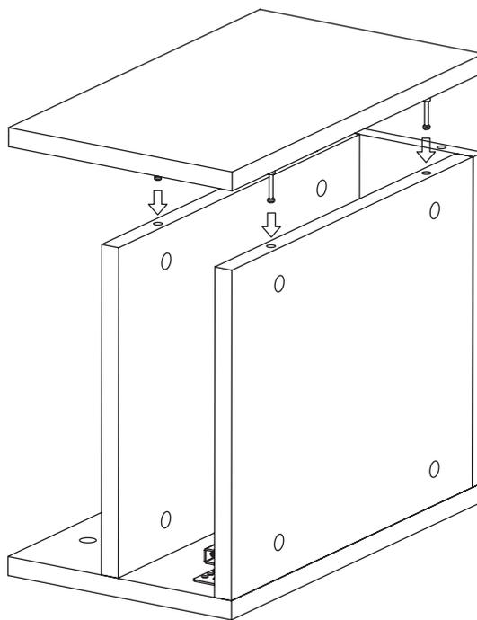
После соединения эксцентрики закрутить по часовой стрелке до упора.
