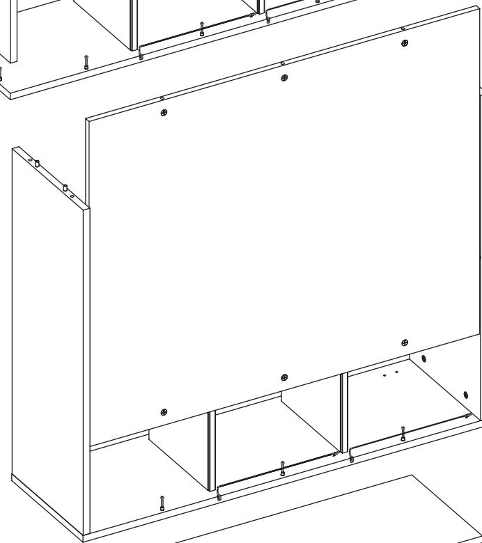
После соединения эксцентрики закрутить по часовой стрелке до упора.
