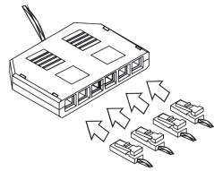
**Не допускается** подключение к блоку питанию нагрузки большей мощности, чем та которая указана в паспорте блока питания. В один блок питания можно подключить не более 2-х шкафов, или 3-х метров светодиодной ленты (мощность ленты 9,6 Вт/м).
