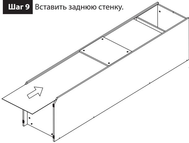
Закрепить задние стенки фиксаторами, как показано на рисунке. Прибить гвоздями стенку заднюю к стенке нижней и полкам, согласно схеме.
