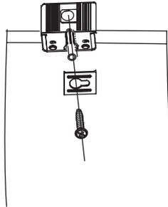
**ВНИМАНИЕ!** Изделие должно быть прикреплено к стене с помощью прилагаемого крепежа который подходит для крепления шкафа к стене из бетона или кирпича без пустот.
