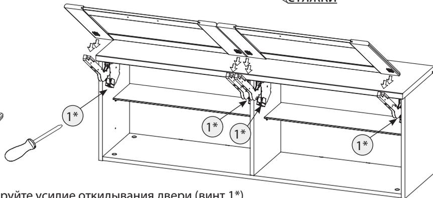
Отрегулируйте усилие откидывания двери (винт 1\*).
