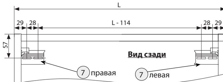
Просверлить отверстия диаметром 6 мм в стене по указанной схеме. В данные отверстия забить дюбели (12). С помощью шурупов (19) закрепить ответные планки.
