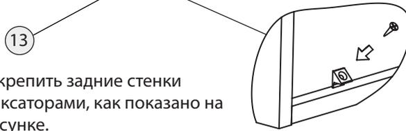
Закрепить задние стенки фиксаторами, как показано на рисунке.
