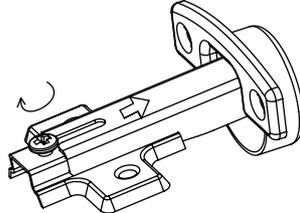
После установки зафиксировать при помощи винта.
