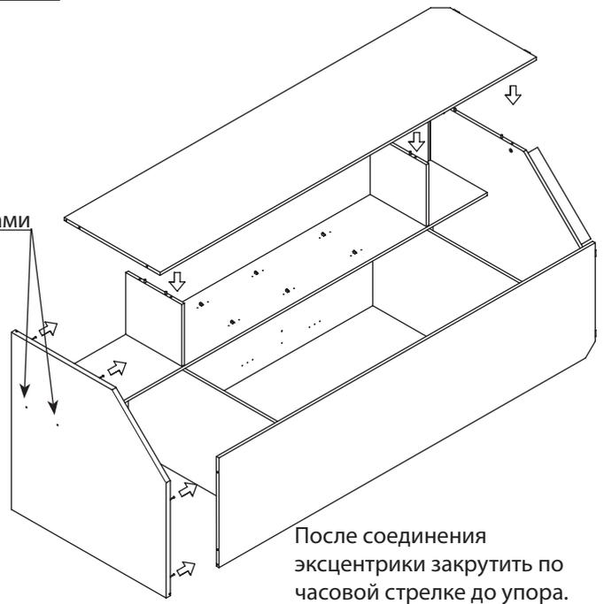
**Шаг 14** Крепление задних стенок
