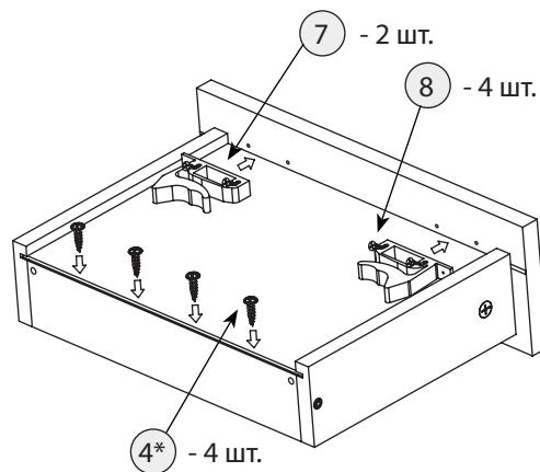
\*Необходимо предварительно просверлить отверстия строго по центру торца задней стенки сверлом d=3мм, глубиной 25мм. Количество отверстий = количеству шурупов.
