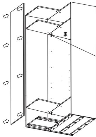
После установки боковой стенки затяните полочные стяжки, поворачивая по часовой стрелке эксцентрик
