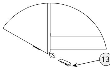
Для выравнивания корпуса относительно пола используйте установочные клинья.
