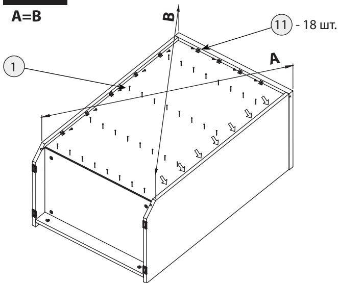
Проверить длину диагоналей, **A=B**. Прибить гвоздями заднюю стенку к стенке нижней и закрепить ее в пазах стенок боковых и крышки фиксаторами задней стенки.
