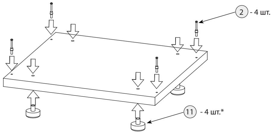
\* - подпятник войлочный (23) использовать в зависимости от типа напольного покрытия (по необходимости), чтобы избежать его повреждение
