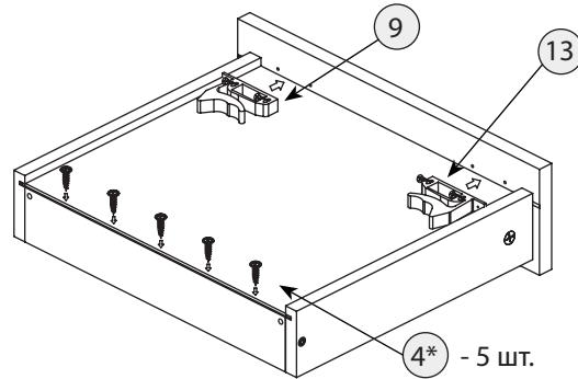
\*Необходимо предварительно просверлить отверстия строго по центру торца задней стенки сверлом d=3мм, глубиной 25мм. Количество отверстий = количеству шурупов.
