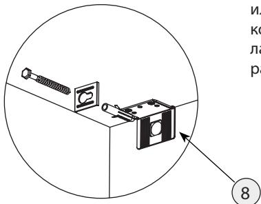
**Внимание!** Изделия должны быть закреплены на стене с помощью прилагаемого крепежа, который подходит для крепления шкафа к стене из бетона или кирпича без пустот. Всегда выбирайте крепеж, который подходит к материалу Ваших стен. Если прилагаемый крепеж не подходит к Вашим стенам, обратитесь в специализированный магазин.
