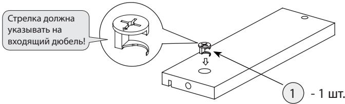
После соединения эксцентрики закрутить по часовой стрелке до упора.
