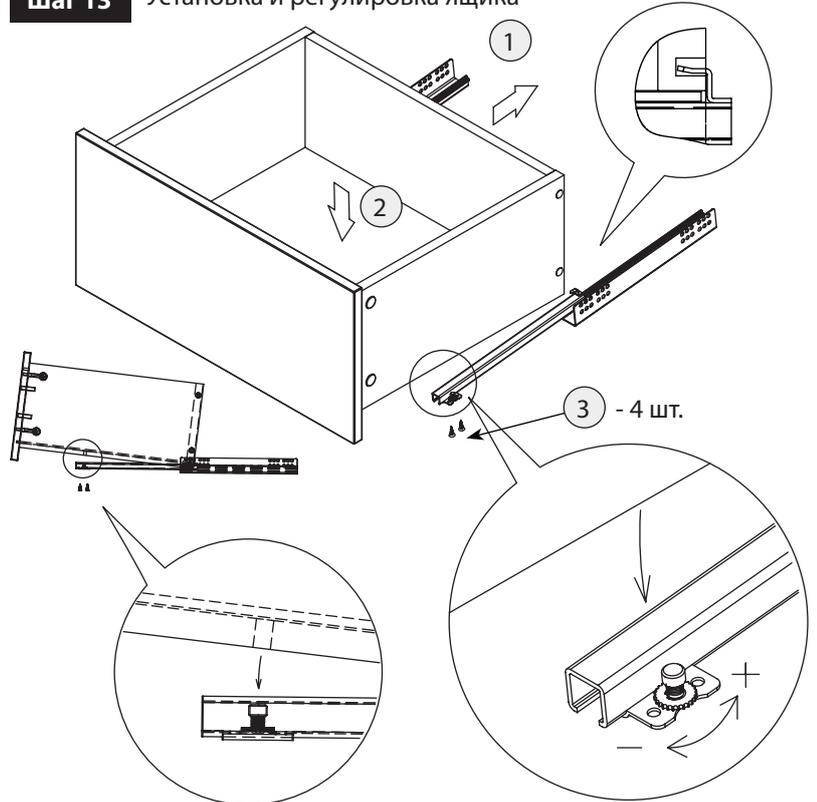
Регулировка ящика по высоте производится с помощью поворота регулировочного колесика (+3 мм)
