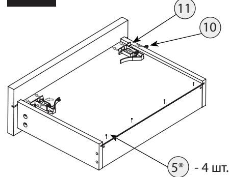
\*Необходимо предварительно просверлить отверстия строго по центру торца задней стенки сверлом d=3мм, глубиной 25мм. Количество отверстий = количеству шурупов.
