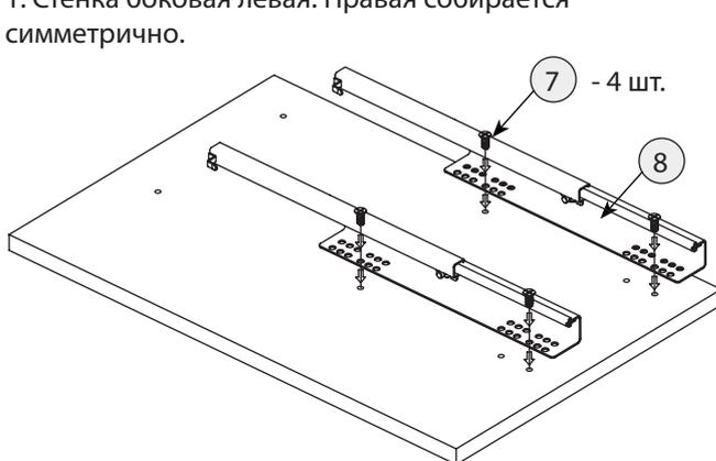
2. При фиксации стенки боковой к боковине шкафа, упереть ее в заднюю стенку.
