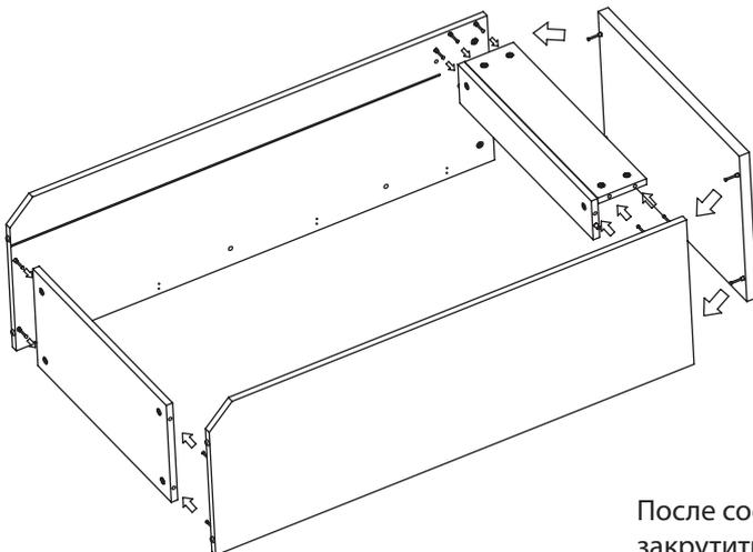
После соединения эксцентрики закрутить по часовой стрелке до упора.
